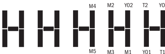
Рисунок 47 – Монитор состояния промежуточных реле
