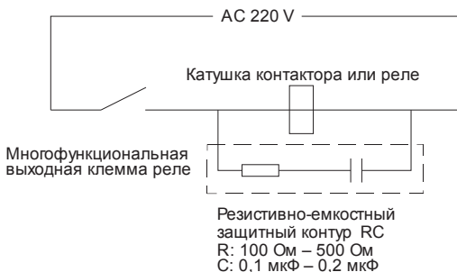
Рисунок 17 — Подключение выходного реле на переменный ток
