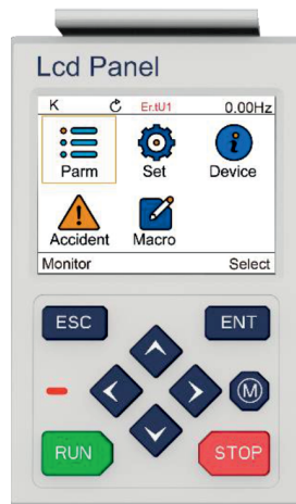
Рисунок 4.18 – Внешний вид LCD-пульта управления RCP-K750-LCD
